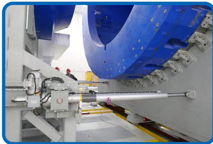
Рис. 1. Монтаж системы перемещения магнитопровода. Слева: основные штоки с рабочим усилием до 70 тонн, справа: штоки с рабочим усилием до 5 тонн для перемещения транспортной опоры полюсов.
